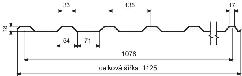
Vhodný jako střešní i fasádní profil. Uvedený plech je možné využít i jako levné řešení při rekonstrukci střech rodinných domů bez nutnosti výměny původního laťování.
