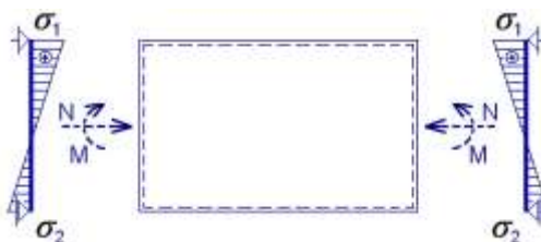
Obr. 1.10: Namáhanie steny kombináciou tlaku a ohybu
